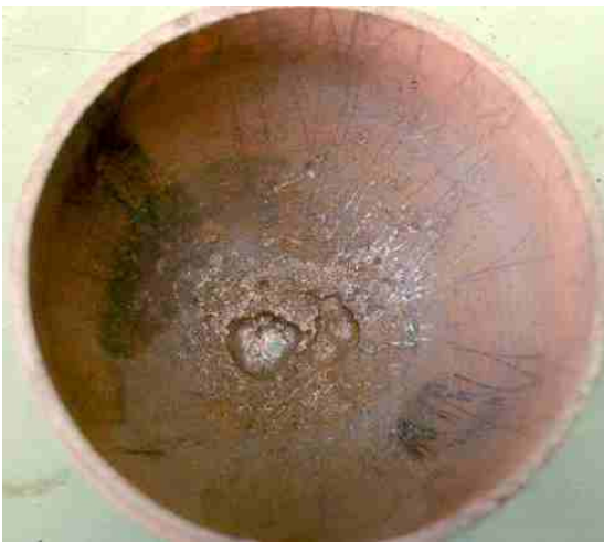
Lochfrass im Boden einer Taucherflasche
